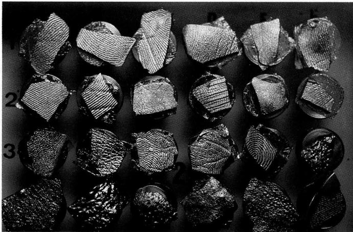
Abbildung 1. Exaktes Positivmodell von Hautleistenabformungen nach Goldbesputterung zur rasterelektronenmikroskopischen Untersuchung.
